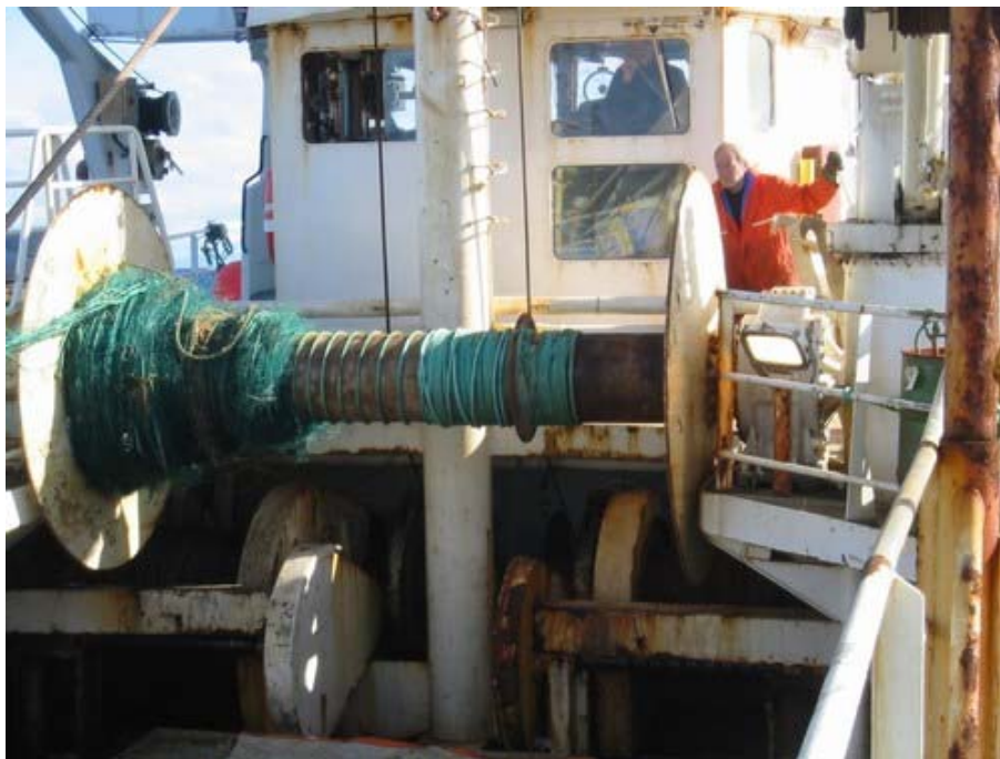
Figur 7. Garnlenke blir kjørt inn på nettrommelen.
